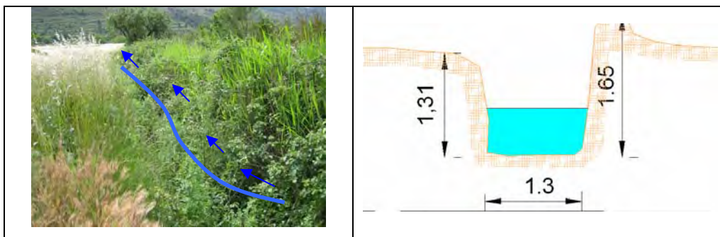
Figura 2: Morfologia del barranc Innominat i croquis de la secció tipus.
